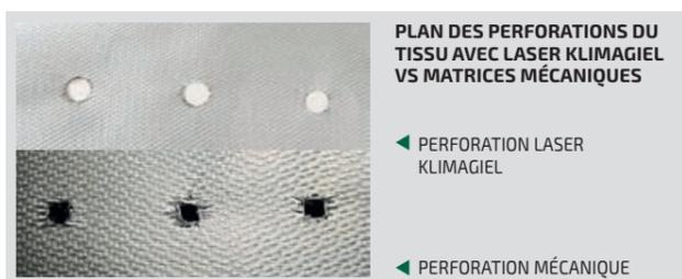
KLIMAGIEL s'engage à respecter l'environnement et propose des gaines de diffusion d'air fabriquées à 100 % avec un **tissu recyclé**. Ce tissu, dérivé de polyester recyclé, assure une distribution de l'air de haute qualité, idéale pour les environnements de plus en plus axés sur le développement durable.
