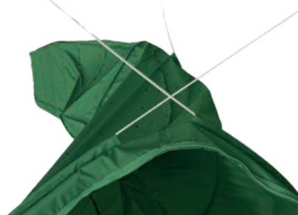
VU INTERNE DE LA GAINÉ AVEC ANNEAUX DE RAIDISSEMENT
