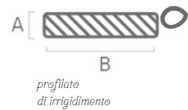
Durante la fase di realizzazione vengono cucite all'interno del canale delle apposite tasche che andranno ad accogliere le stecche di irrigidimento realizzate in vetroresina rinforzata con fibra di vetro.
