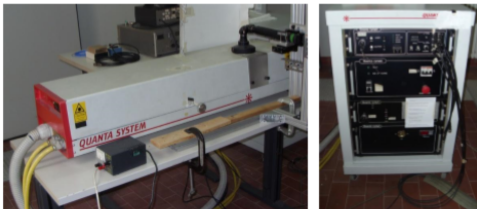
Figura 6.7 Laser (sinistra) e sistema di alimentazione e controllo (destra)
