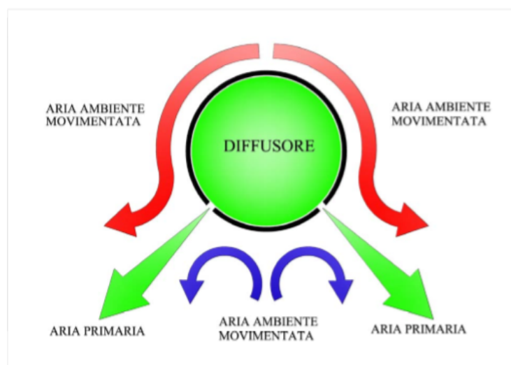
Figura 4.6 Illustrazione del principio di funzionamento di un diffusore microforato
