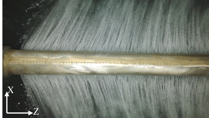
Figura 5.6 Diffusore operante in aria e visualizzazione dell'angolo di uscita, vista dall'alto
