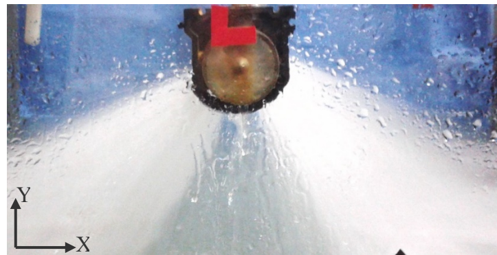
Figura 5.5 Visualizzazione dei getti principali del diffusore, vista frontale
